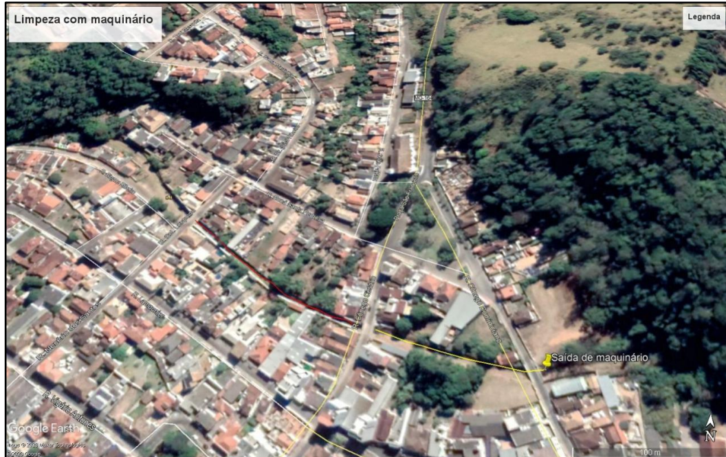
Figura 2 - Trecho do Rio Vermelho onde ocorrerá passagem do maquinário e dragagem/desassoreamento do canal concretado (em vermelho).
