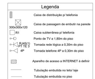
NOTAS: 1) A Ligação dos pontos de TV deverão ser feitas pelo telhado. Cada ponto deverá ter eletroduto embutido na parede com suas ligações feitas sobre a laje.
