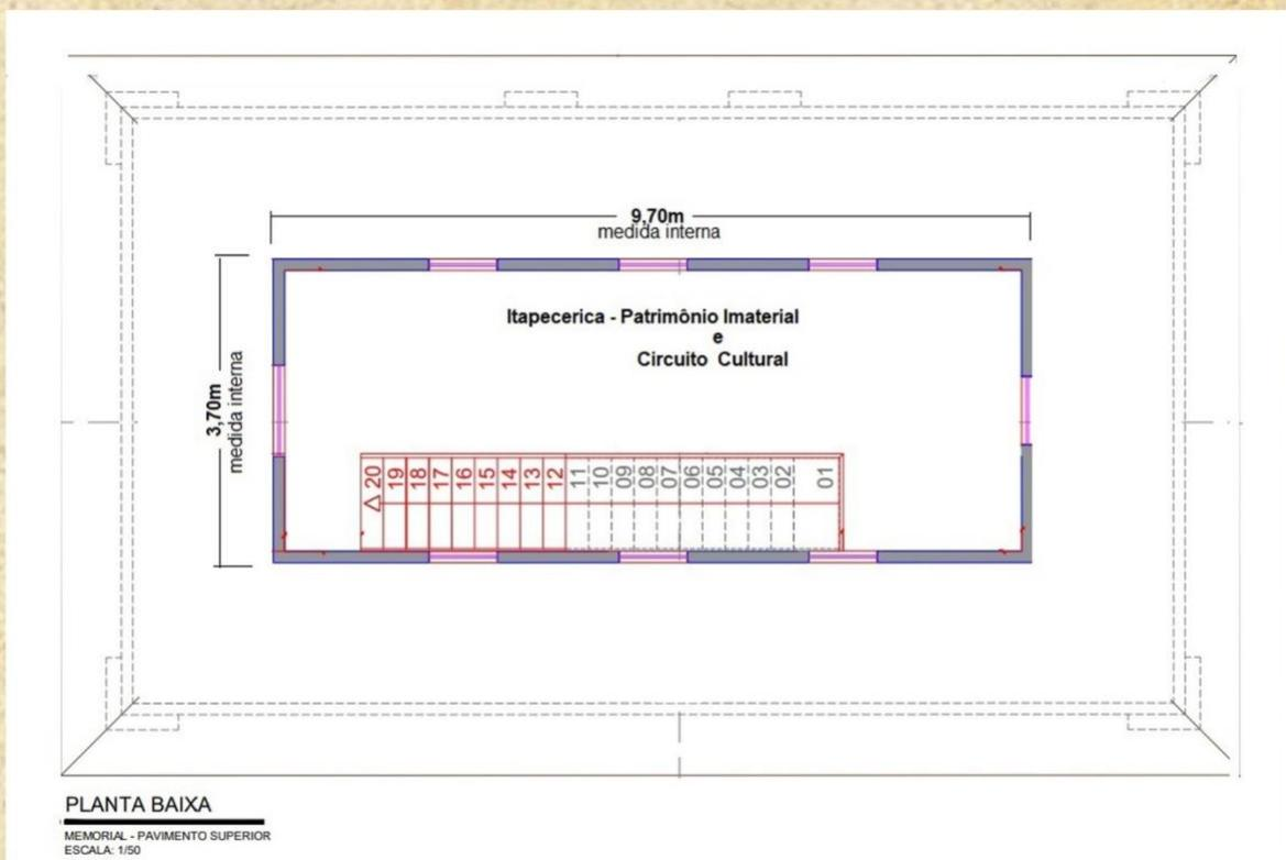
Nossa proposta para o Memorial de Itapeceira prevê a divisão interna em 5 ambientes que se comunicam, sendo essas paredes internas montadas com placas de gesso ( drywall ), que serão disponibilizadas pela prefeitura . O projeto acima mostra a disposição e medidas das divisões.
